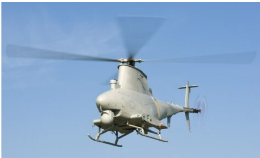
De MQ8B Fire Scout is een helikopterdrone. De US Navy is fier dat zij deze drone heeft ontwikkeld met een motor op biobrandstof. Foto: Kelly Schindler/Public Domain
