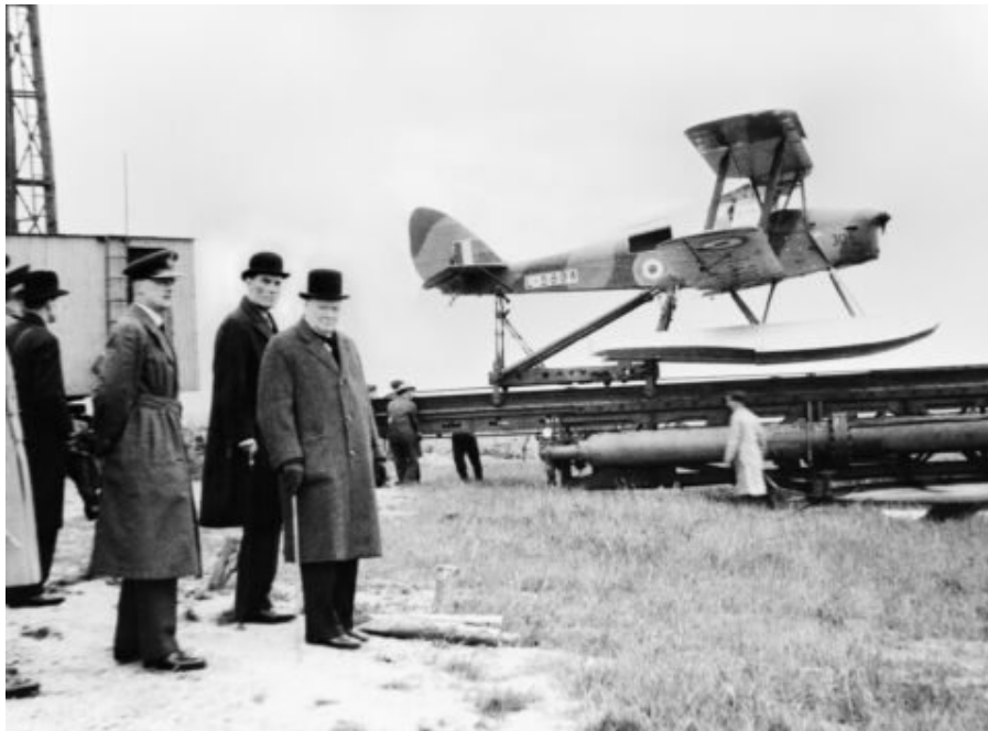
Winston Churchill kijkt toe op de lancering van een Havilland Queen Bee zonder piloot op 6 juni 1941, een omgebouwde Tiger Moth tweedekker. Toestellen zonder piloot waren al een militair idee sinds vliegtuigen bestaan. Beperkende factoren waren het geringe bereik van het radiosignaal, gebrek aan visuele controle met camera aan boord en het gewicht van de klassieke verbrandingsmotor. Foto: Imperial War Museum/Public Domain
